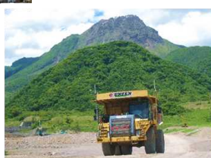
右図：無人化施工重機
