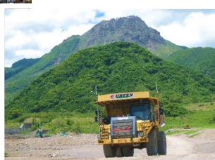
右図：無人化施工重機
