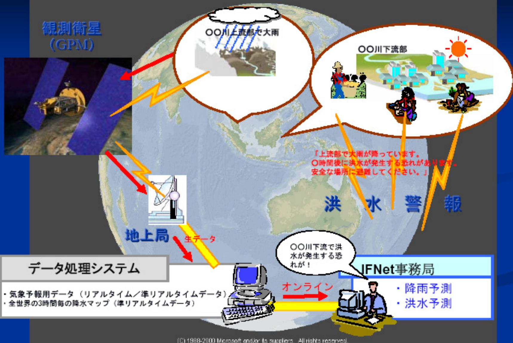
システムの全貌を簡単に説明します。たとえば、東南アジアのある河川上流部で大雨が発生したとします。その状況を衛星 GPM が観測し、情報を地上局に届けます。データ処理システムにより処理された気象予報用データは、オンラインで IFNet 事務局に運ばれ、河川の下流域に住む人々に「洪水警報」を送ります。
