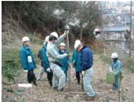
簡易貫入試験器では1打撃毎の貫入量を自動記録でき比較的簡易に安価での土層厚把握が可能。
