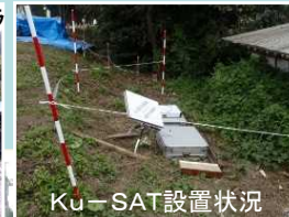
監視体制の構築(Ku-SAT、ワイヤーセンサー設置)
