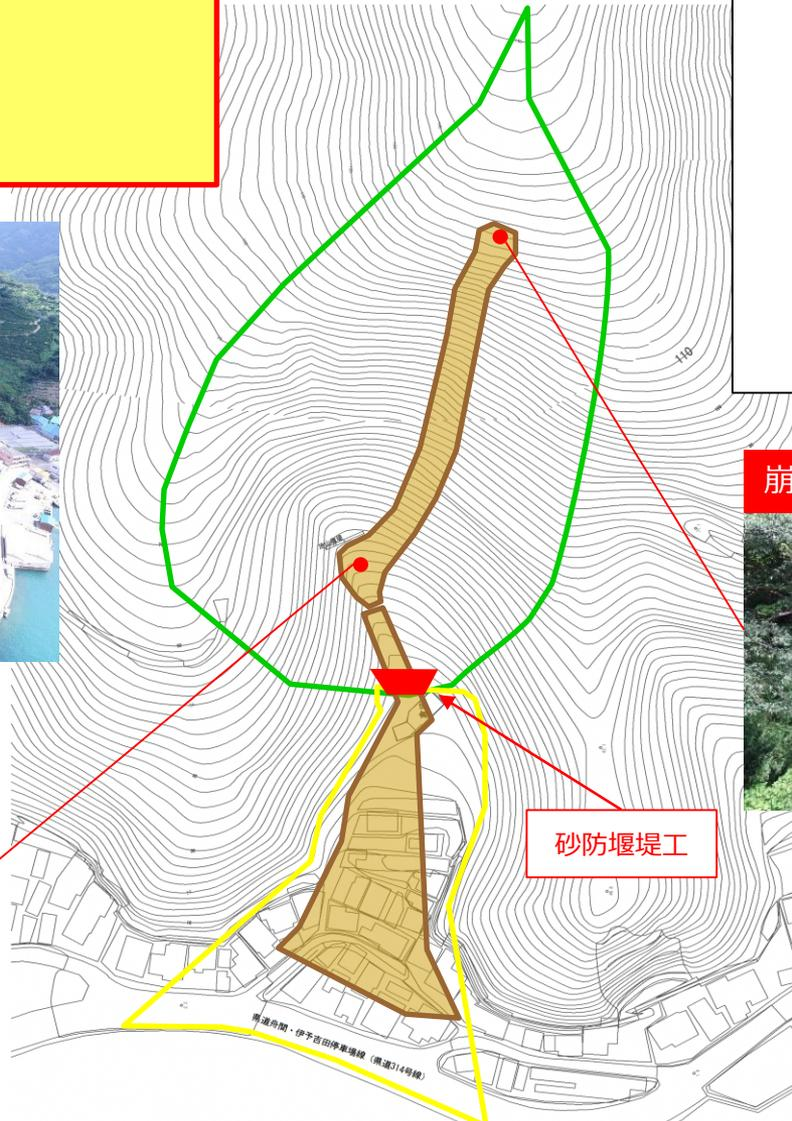
砂防堰堤工
