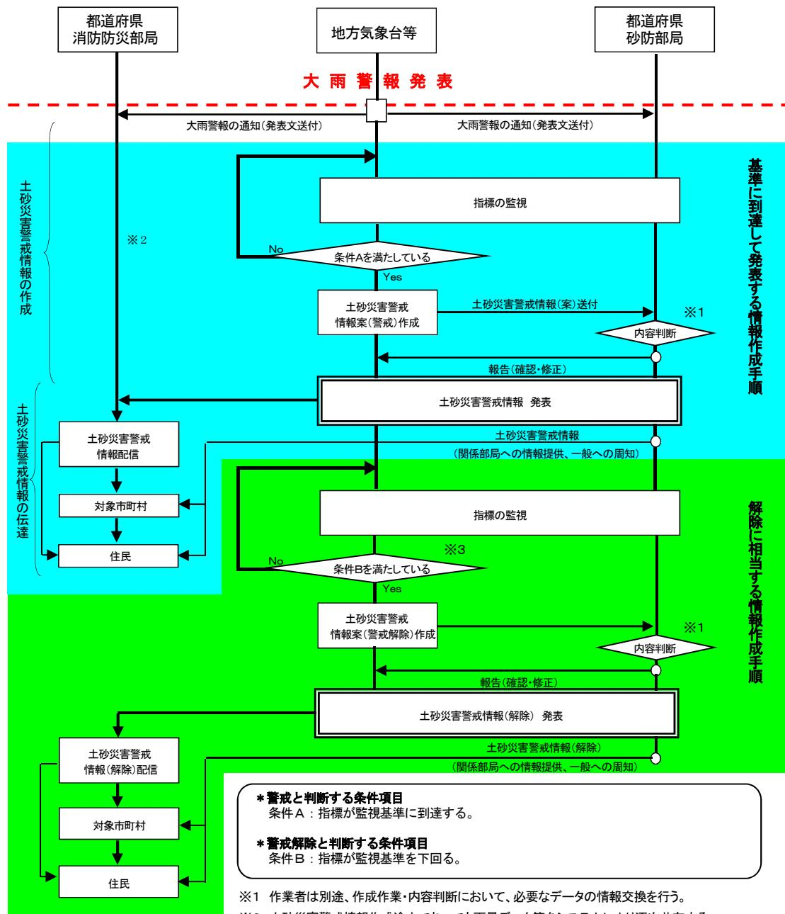
図3 土砂災害警戒情報の作成・伝達のフロー（例）
