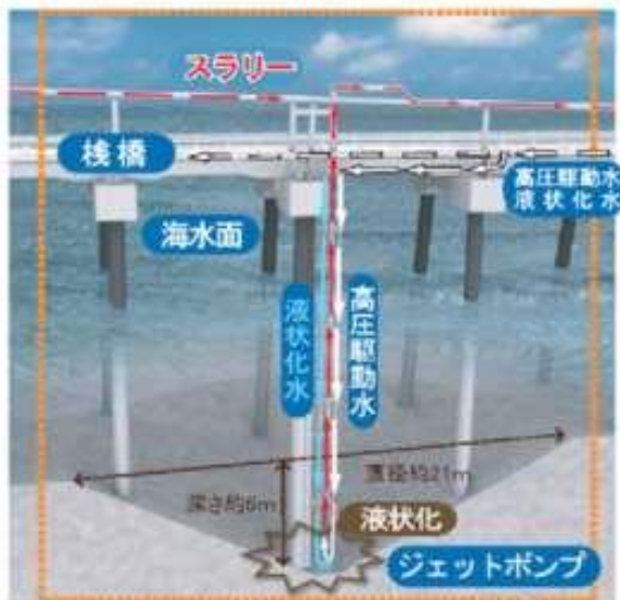
ジェットポンプの仕組み
