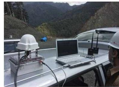
世界的にも衛星を使った IoT 利用が進んだことにより、静止衛星ではあるが従来よりも遥かに大きなアンテナ(20m 程度)を有する衛星 (インマルサット等) も利用出来るようになってきた。そこで本研究開発でも静止衛星を使った通信実証実験を実施し、データ収集を安定的に行うことが出来た。
