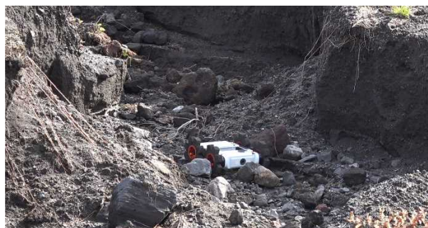
図 5 CLOVER-III の不整地走行試験
