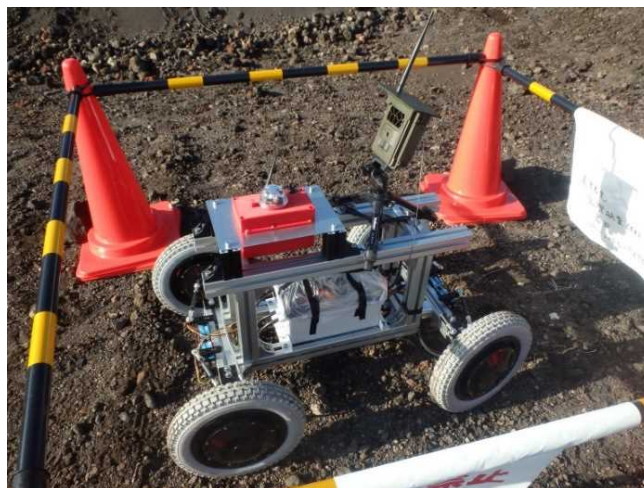
図 6 地表移動ロボットの残置の様子
