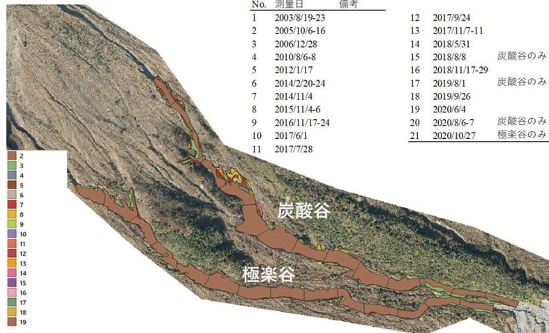
図4 貯留土砂量の変化を計算したガリーの範囲(凡例の数字は右上の表のNo.に対応している)
