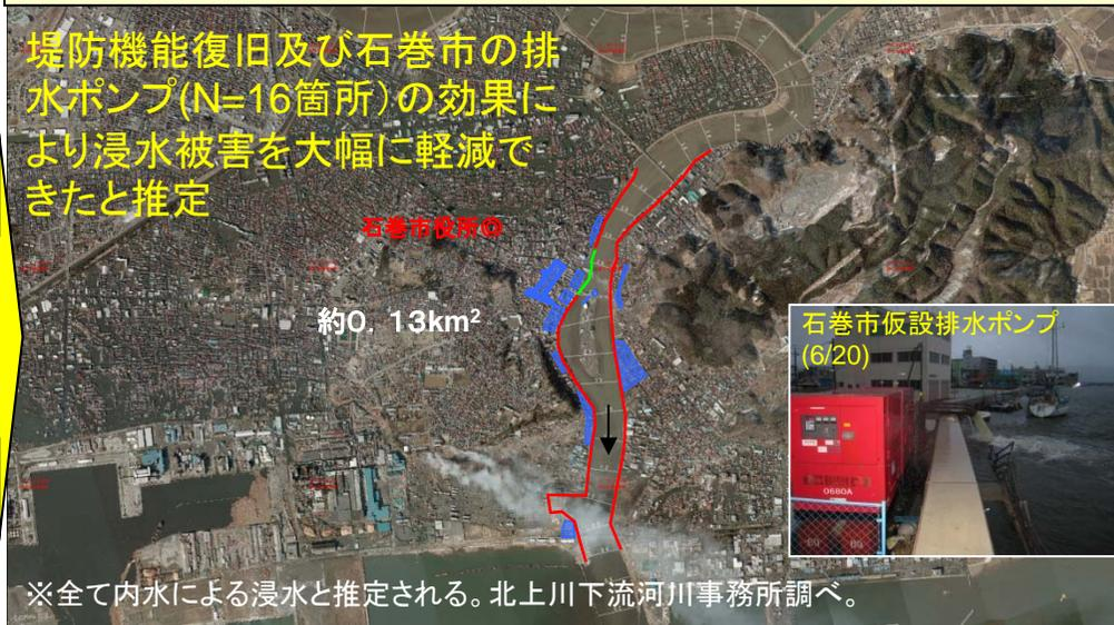
堤防機能復旧及び石巻市の排水ポンプ(N=16箇所)の効果により浸水被害を大幅に軽減できたと推定
