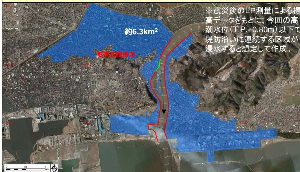
※震災後のLP測量による標高データをもとに、今回の高潮水位(T.P.+0.80m)以下で堤防沿いに連続する区域が浸水すると想定して作成。
