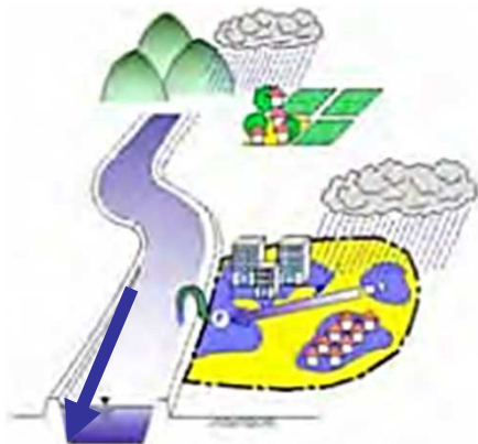
下水道に由来する内水氾濫
