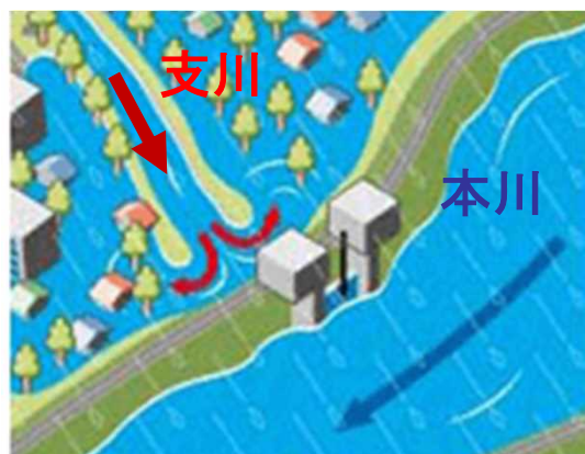
本川に対する支川からの内水氾濫
