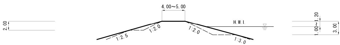
※各河川（区間）における、標準的な堤防の断面形状（破線）を示す。
