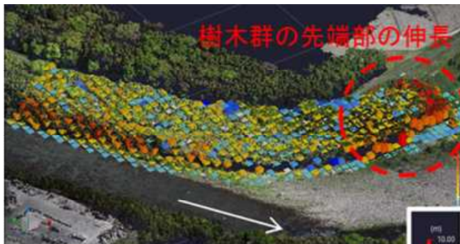
2時期の航空写真測量の重ね合わせにより樹木群の伸長状況を把握した例
