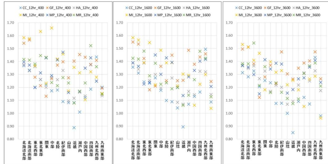
図-9 各地域区分における降雨継続時間 12 時間の海面水温モデル毎の降雨量変化倍率
