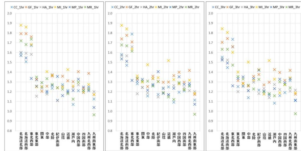
図-14 各地域区分における雨域面積 400km<sup>2</sup>の海面水温モデル毎の降雨量変化倍率
