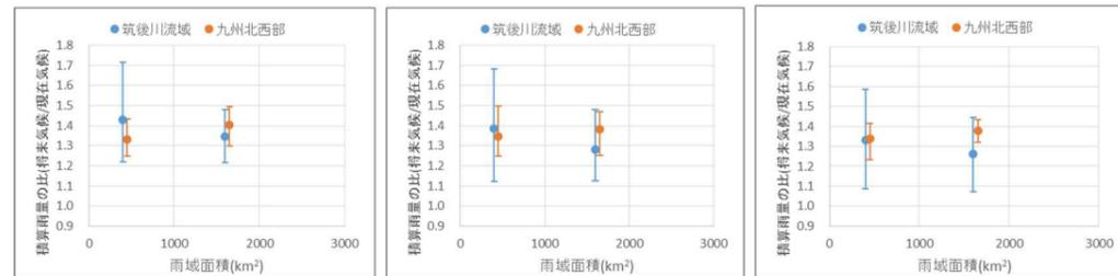
図-19 筑後川流域と九州北西部における d4PDF (5km, SI-CAT) を用いた降雨量変化倍率
