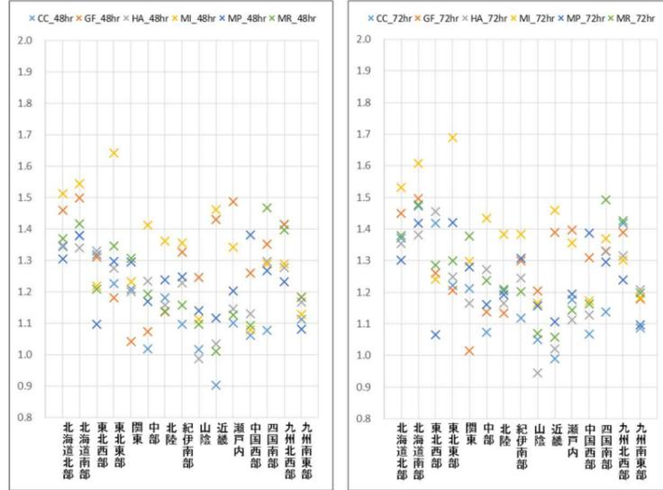
図-16 各地域区分における雨域面積 400km<sup>2</sup>の海面水温モデル毎の降雨量変化倍率
