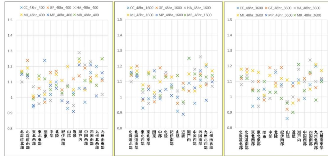
図-20 各地域区分における降雨継続時間48時間の海面水温モデル毎の降雨量変化倍率
