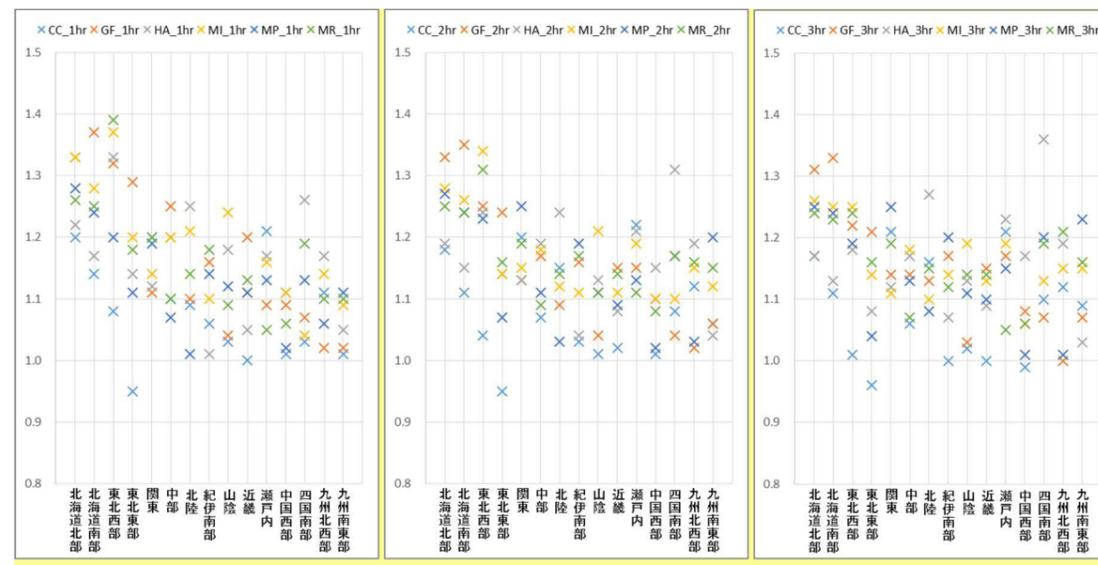
図-23 各地域区分における雨域面積 400km<sup>2</sup> の海面水温モデル毎の降雨量変化倍率
