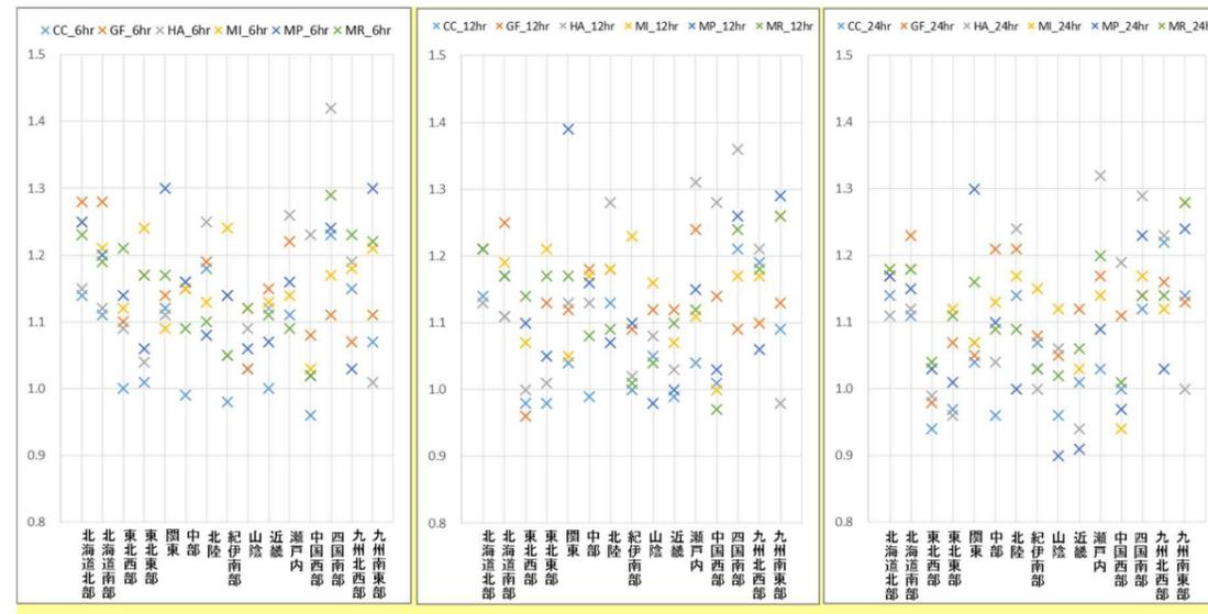
図-24 各地域区分における雨域面積 400km<sup>2</sup>の海面水温モデル毎の降雨量変化倍率
