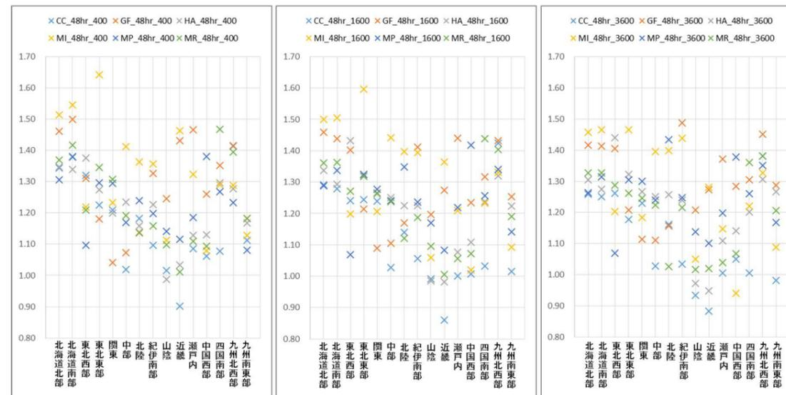
図-11 各地域区分における降雨継続時間 48 時間の海面水温モデル毎の降雨量変化倍率
