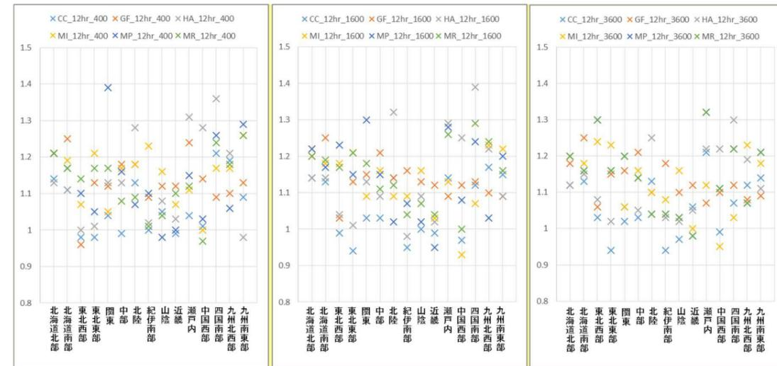
図-18 各地域区分における降雨継続時間 12 時間の海面水温モデル毎の降雨量変化倍率
