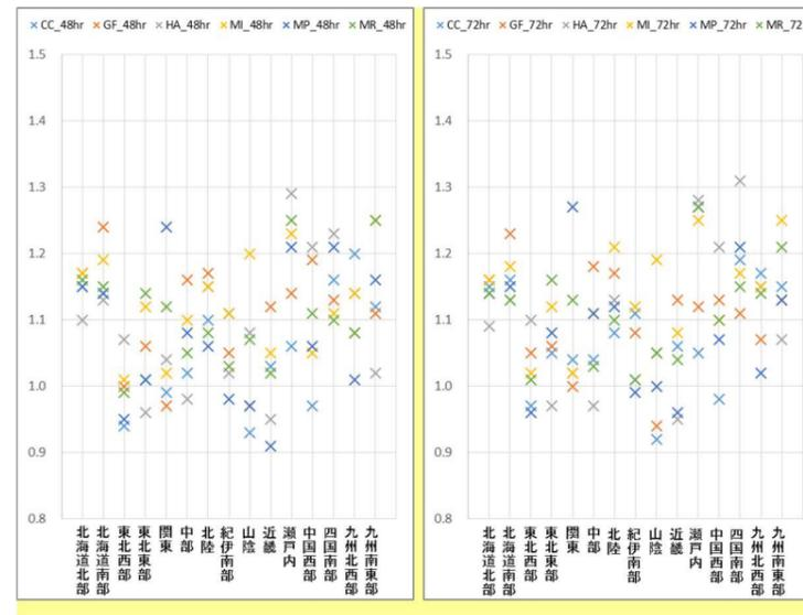
図-25 各地域区分における雨域面積 400km<sup>2</sup>の海面水温モデル毎の降雨量変化倍率
