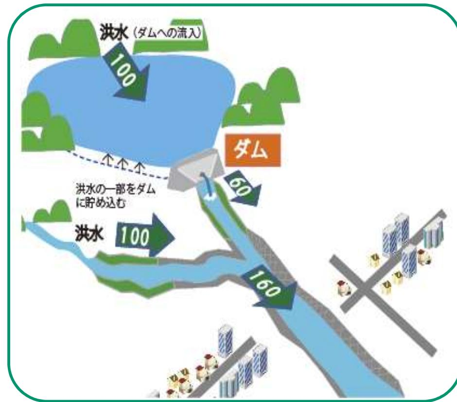
ダムは、下流の河道で氾濫が起きないように上流からの洪水の一部をダムに貯め込んで、下流に流れる水量を低減させる。
