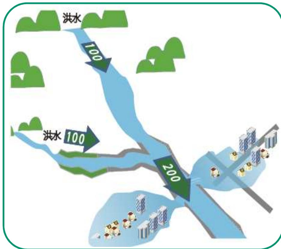
ダムがない場合には、上流からの洪水がそのまま下流に流れ、ダム下流域において氾濫などによる被害が発生する恐れがある。
