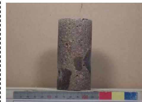
材齢95年 重力式コンクリートダム 堤体部ボーリングコア状況
