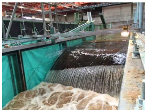
越流実験状況
