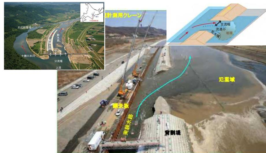
十勝川千代田実験水路破堤実験の実施状況
