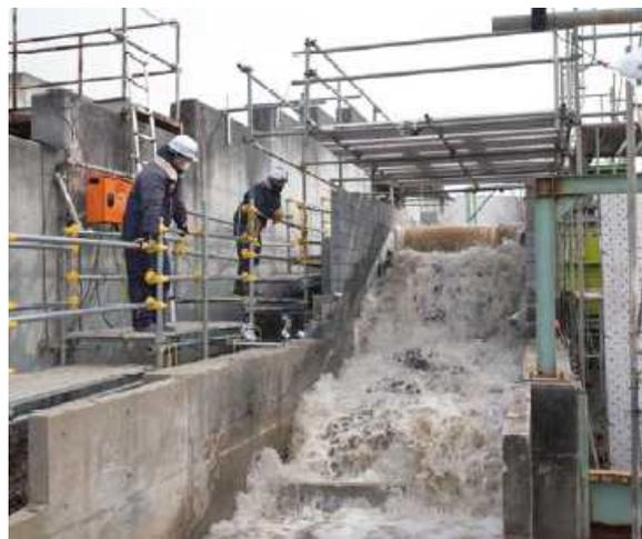
越流実験の実施状況(国総研の実験施設)
