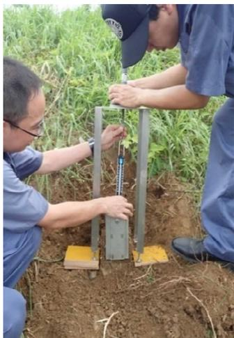
引張り破壊試験の実施状況
