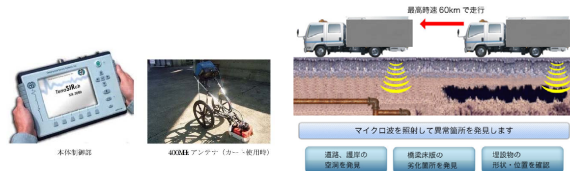
図-2 地中レーダー探査のイメージ
