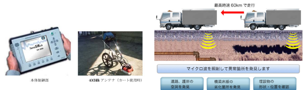
図-2 地中レーダー探査のイメージ
