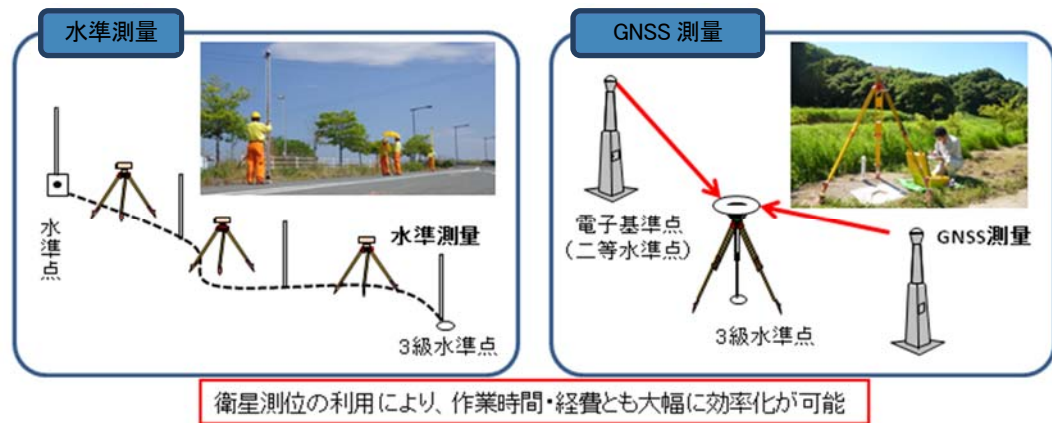
図-1 衛星測位による測量の効率化のイメージ
