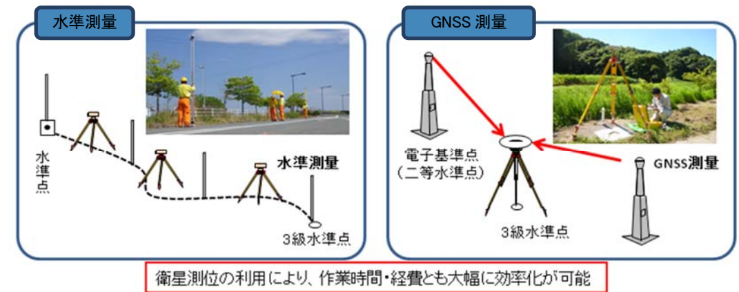
図-1 衛星測位による測量の効率化のイメージ
