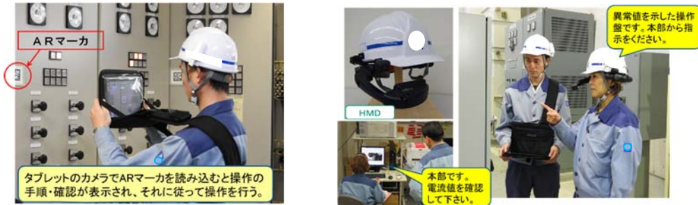
図-5 操作支援のイメージ (左：タブレット 右：ヘッドマウントディスプレイ)
