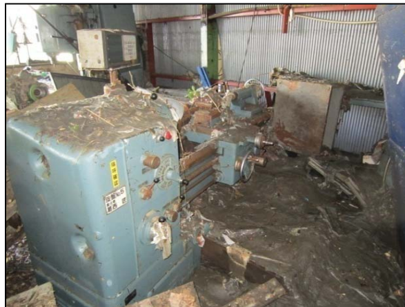
泥に埋もれた機械
