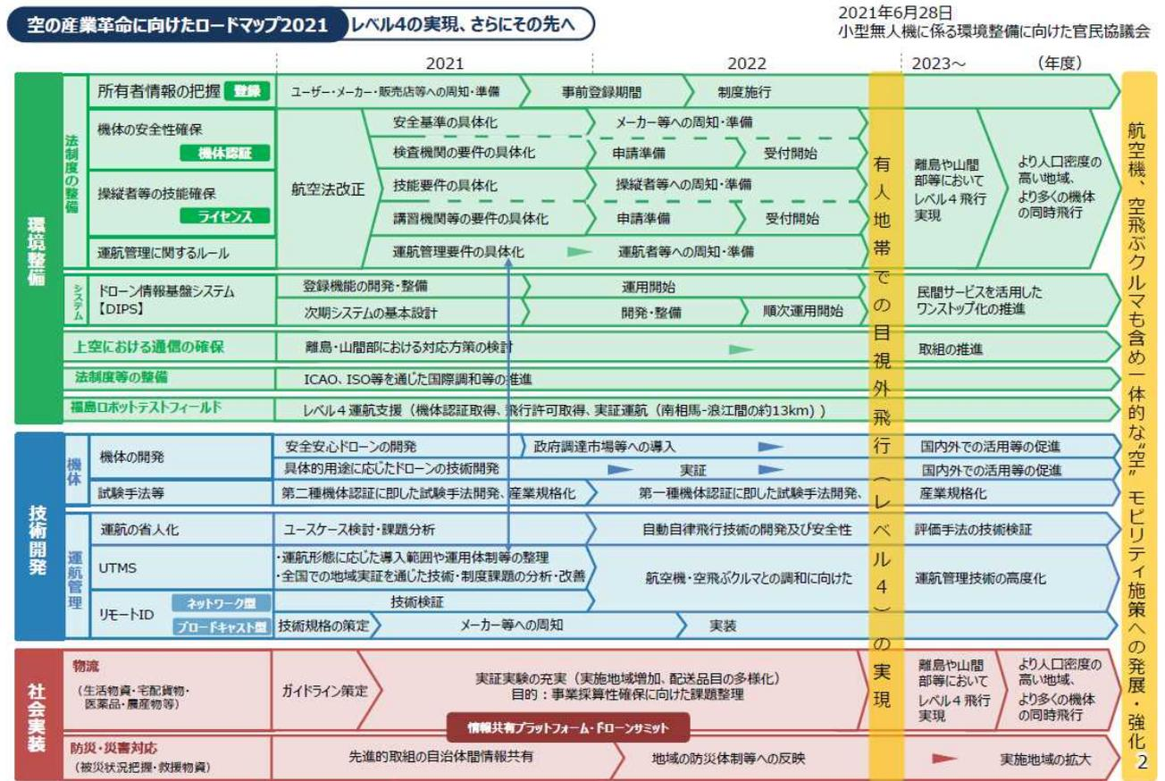
有人地帯での目視外飛行（レベル4）を含め、飛行レベルとそれに伴う制度は、下記のように設定されている。レベル4飛行を実現させるために、機体認証、操縦ライセンス、運航管理方法等の個別確認の許可・承認が必要になる。
