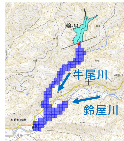
町野川水系鈴屋川(右支川牛尾川)の河道閉塞決壊時におけるの氾濫シミュレーション
