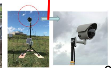
簡易型河川監視カメラの設置
