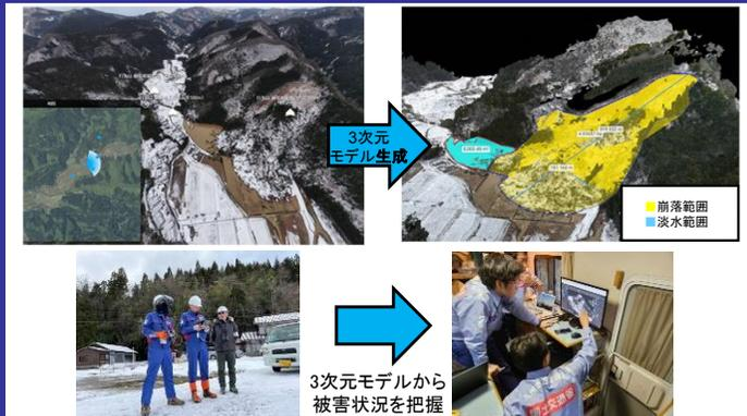
ドローンによる被災地の撮影と3次元化により、被災状況の把握及び対策計画立案を迅速化。
