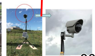
簡易型河川監視カメラの設置
