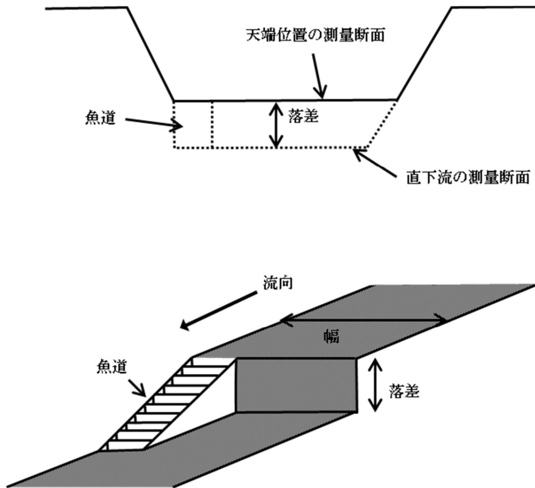
図5-15. 落差工における測量項目
