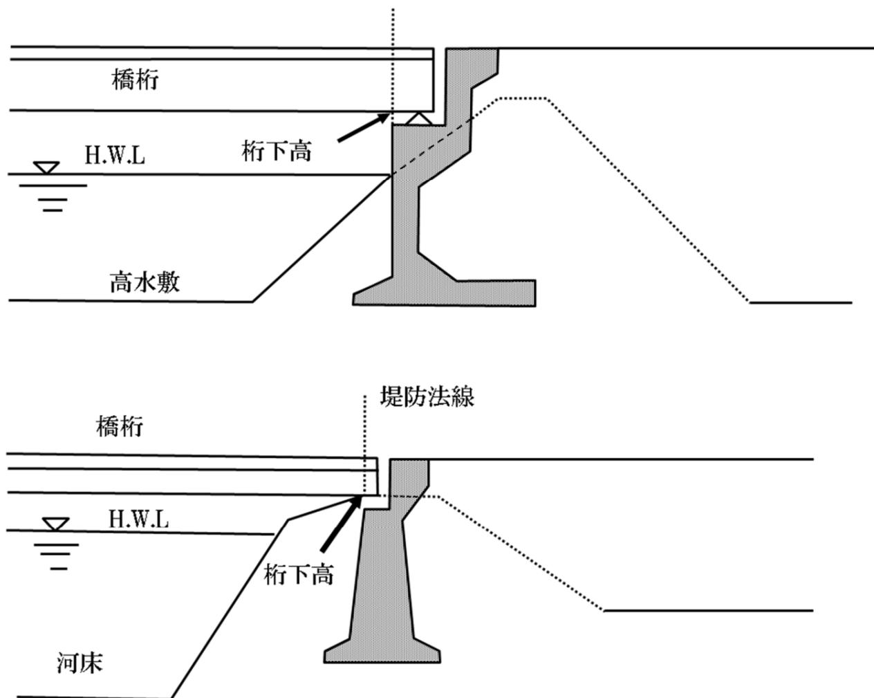
図 4 - 5 . 橋梁の桁下高
