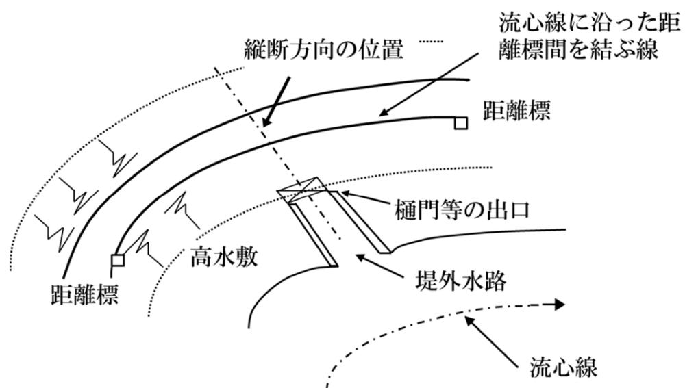
図4-1. 縦断測量時の構造物等の位置
