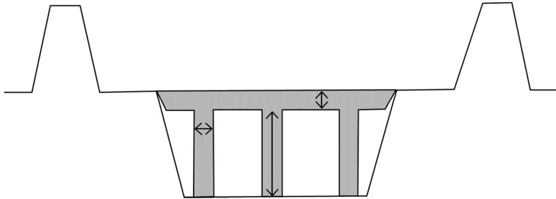
図5-13. 潜水橋における測量項目
