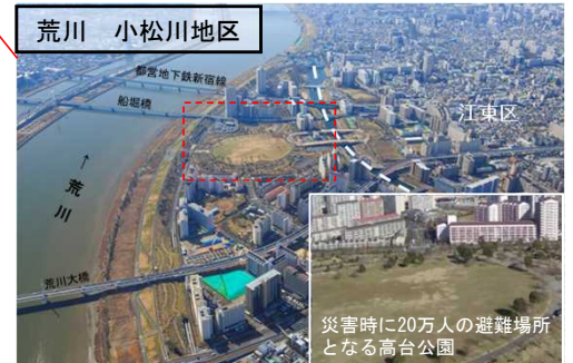
国による高規格堤防の整備(高台公園の整備) (市街地再開発事業等と実施)
