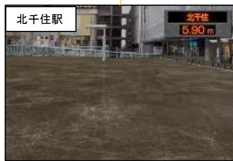
北千住駅周辺 浸水状況 (荒川破堤シミュレーション結果)
