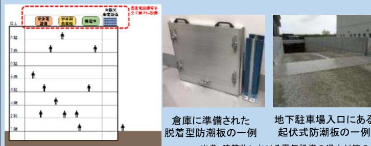
電気設備の屋上設置イメージ
