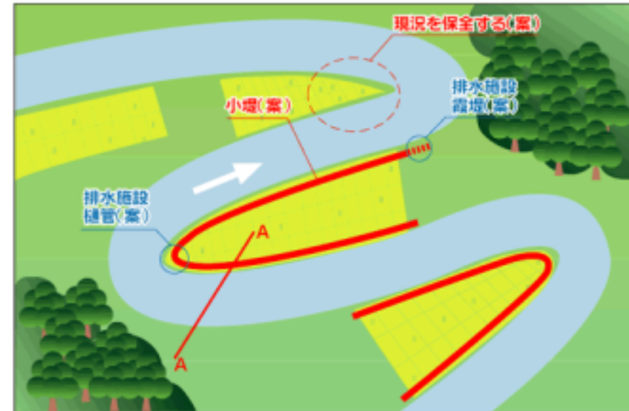
●小堤(案)の計画図(平面図)
