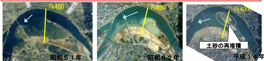
河床の安定を考慮し、深掘対策・高水敷造成・堤防の拡幅を行った上で、左岸高水敷の一部を掘削すれば概ね8,000m<sup>3</sup>/sの河道断面の確保は可能
