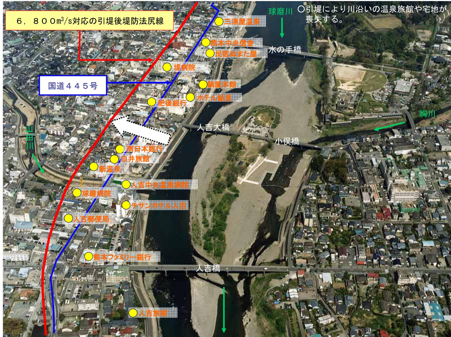
既設の市房ダムで調節し、残りを河道で処理した場合の人吉地点流量6,800m<sup>3</sup>/sに対応する嵩上げを実施した場合、重要な観光資源である川沿いの多数の温泉旅館等を含む約820戸(球磨川沿い約310戸、支川嵩上げ・道路嵩上げ等約510戸)の移転が必要。
