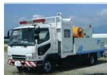
移動式排水施設
