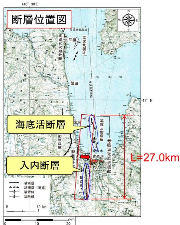
図-4 地震津波の波源域を設定
