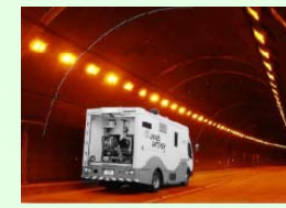
レーザを用いた覆いひび割れ点検車
