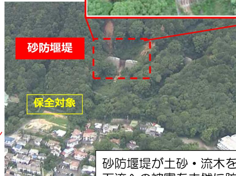
砂防堰堤が土砂・流木を捕捉し下流への被害を未然に防止
