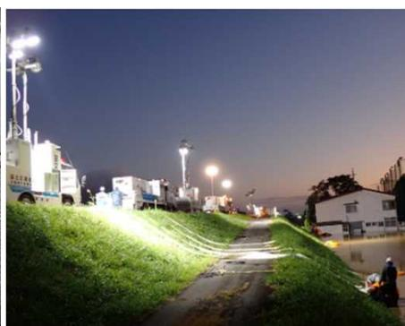
排水ポンプ車による24時間体制の緊急排水
