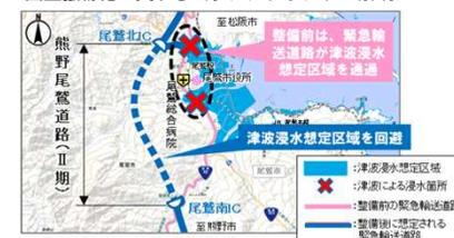
ミッシングリンクの解消により、津波浸水想定区域を回避するネットワークを確保
