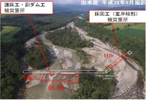
戸蔦別川床固工群の土砂流下状況
