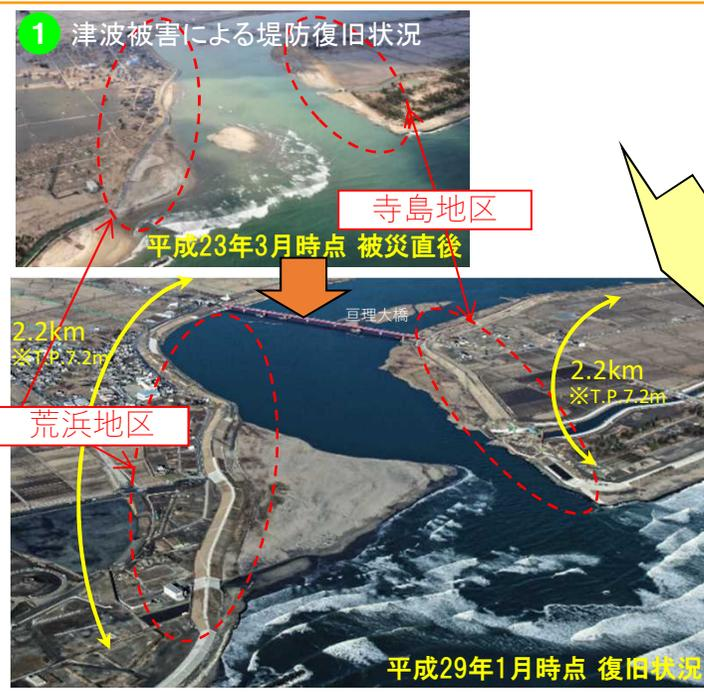
写真① 津波によって崩壊した堤防及び堤防復旧状況(右岸:荒浜地区 左岸:寺島地区)
