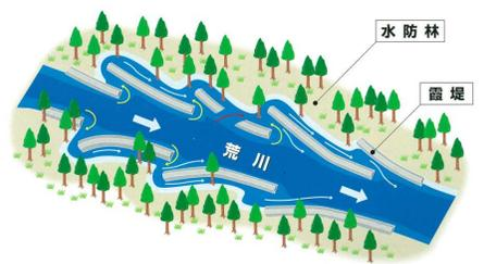
荒川で整備されている霞堤と水防林による洪水時の治水イメージ
