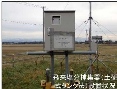
飛来塩分捕集器(土研式タンク法)設置状況
