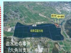
新たな洪水調節施設の整備の例
