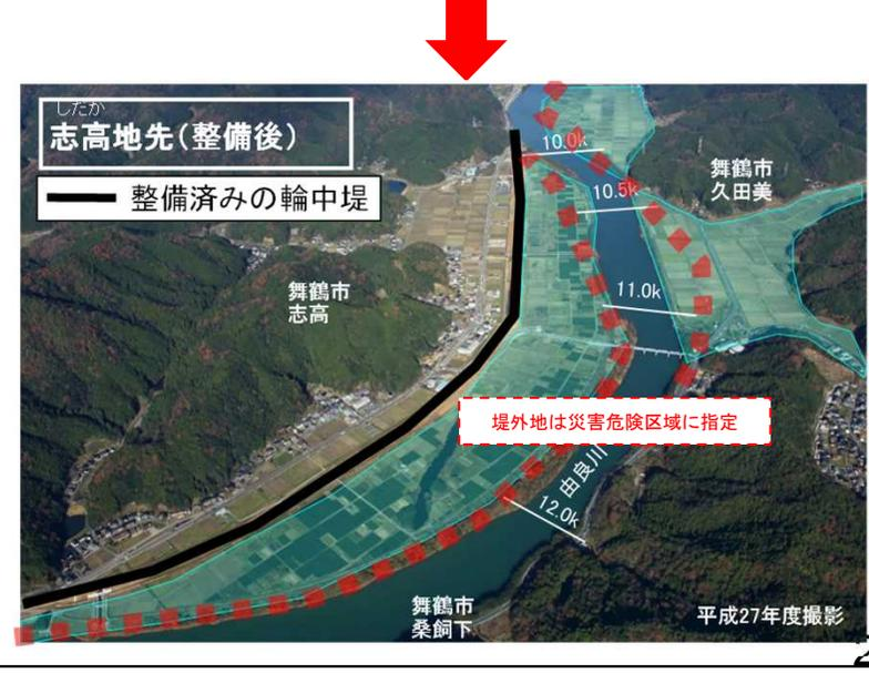
○現HWL(堤防高)・現計画堤防法線を踏襲した上で、河道内樹木は全て伐採、堤防防護に必要な高水敷幅までの範囲で掘削し、下流部の狭隘部では、さらに家屋等への影響等を最小限にとどめるよう考慮しつつ、河道の拡幅の可能性を検討したところ、下流部の狭隘部で8,100m<sup>3</sup>/s、福知山地点の換算で6,700m<sup>3</sup>/sまで河道配分流量を増大可能であることを確認した。
