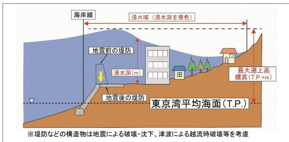
図 1 最大遡上高と浸水深の模式図
