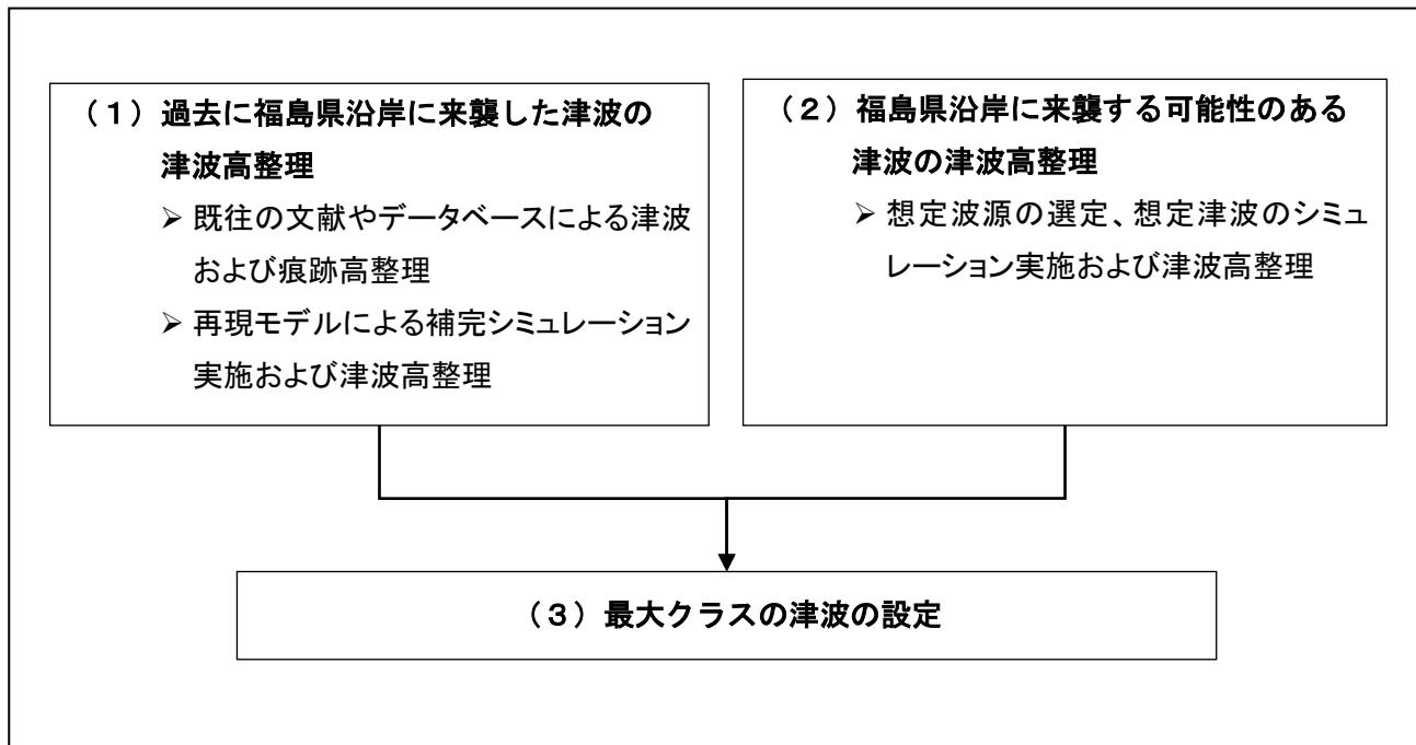
図 6 最大クラスの津波の設定フロー
