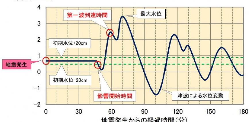
図 4 影響開始時間、第一波到達時間の模式図
