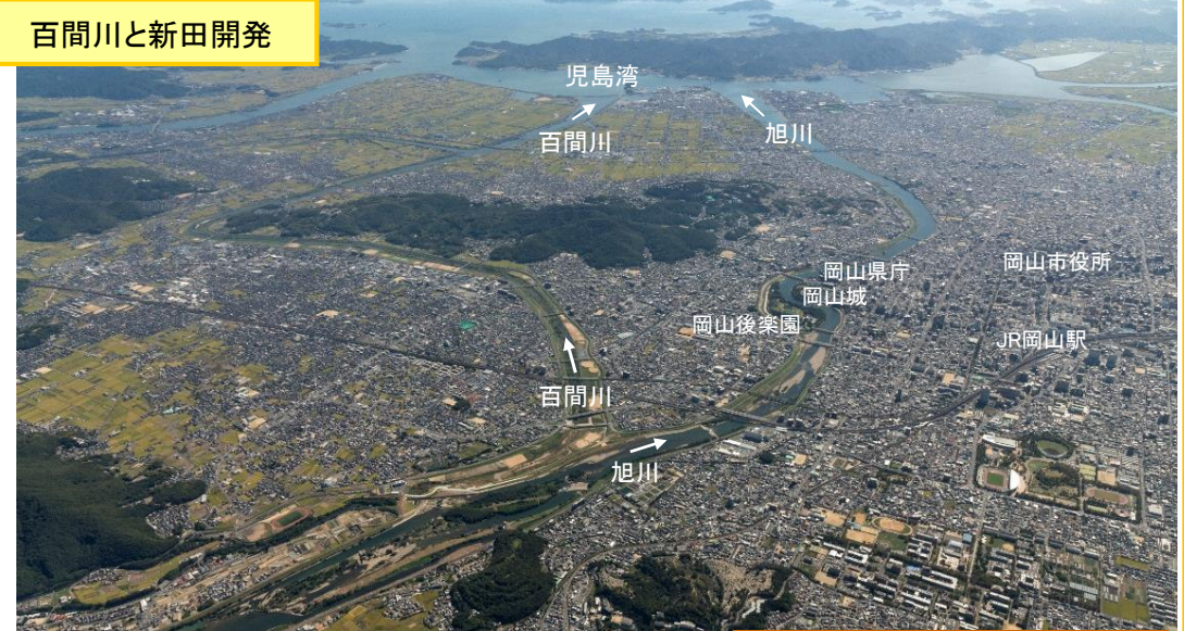
百間川の整備により、治水（岡山城下の浸水被害の軽減）と新田開発（人口増加による食料増産対策）を両立させた
