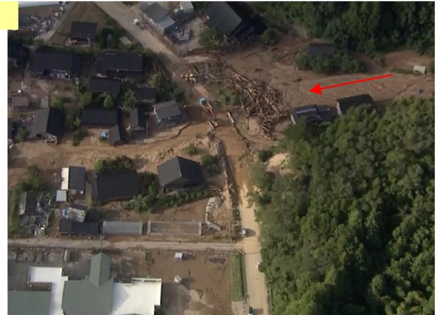
土砂、流木が流出して横断工作物(橋)を閉塞、氾濫が拡大
