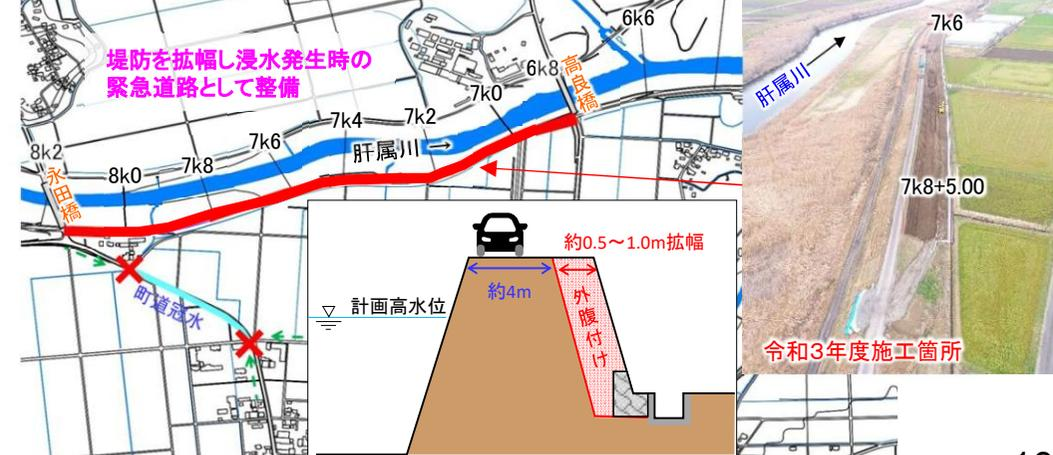
堤防を拡幅し浸水発生時の緊急道路として整備
