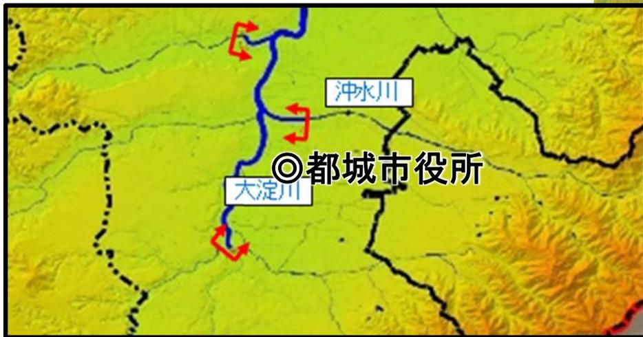
○ 気候変動による降雨量の増加等を考慮し設定した基本高水のピーク流量13,400m<sup>3</sup>/s(基準地点柏田地点)を、洪水調節施設等により3,700m<sup>3</sup>/s調節し、河道への配分流量を 9,700 m<sup>3</sup>/sとする。
