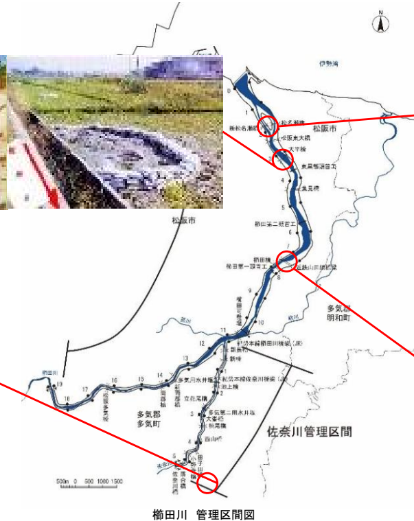
下流部において計画高水位を上回り、漏水が発生するなど堤防が危険な状態
