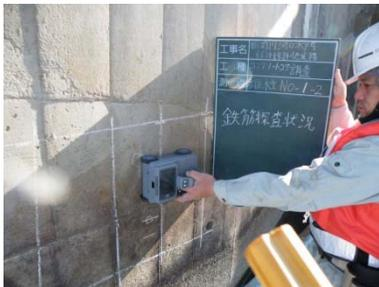
内部鉄筋探査状況
