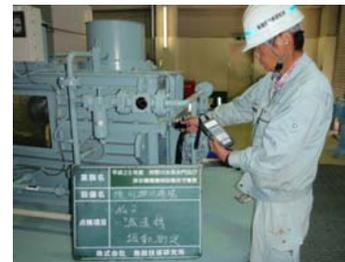
主原動機振動測定状況
