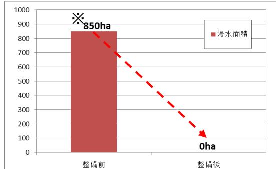
※計画高水位で堤防が決壊した場合の浸水被害を推定
