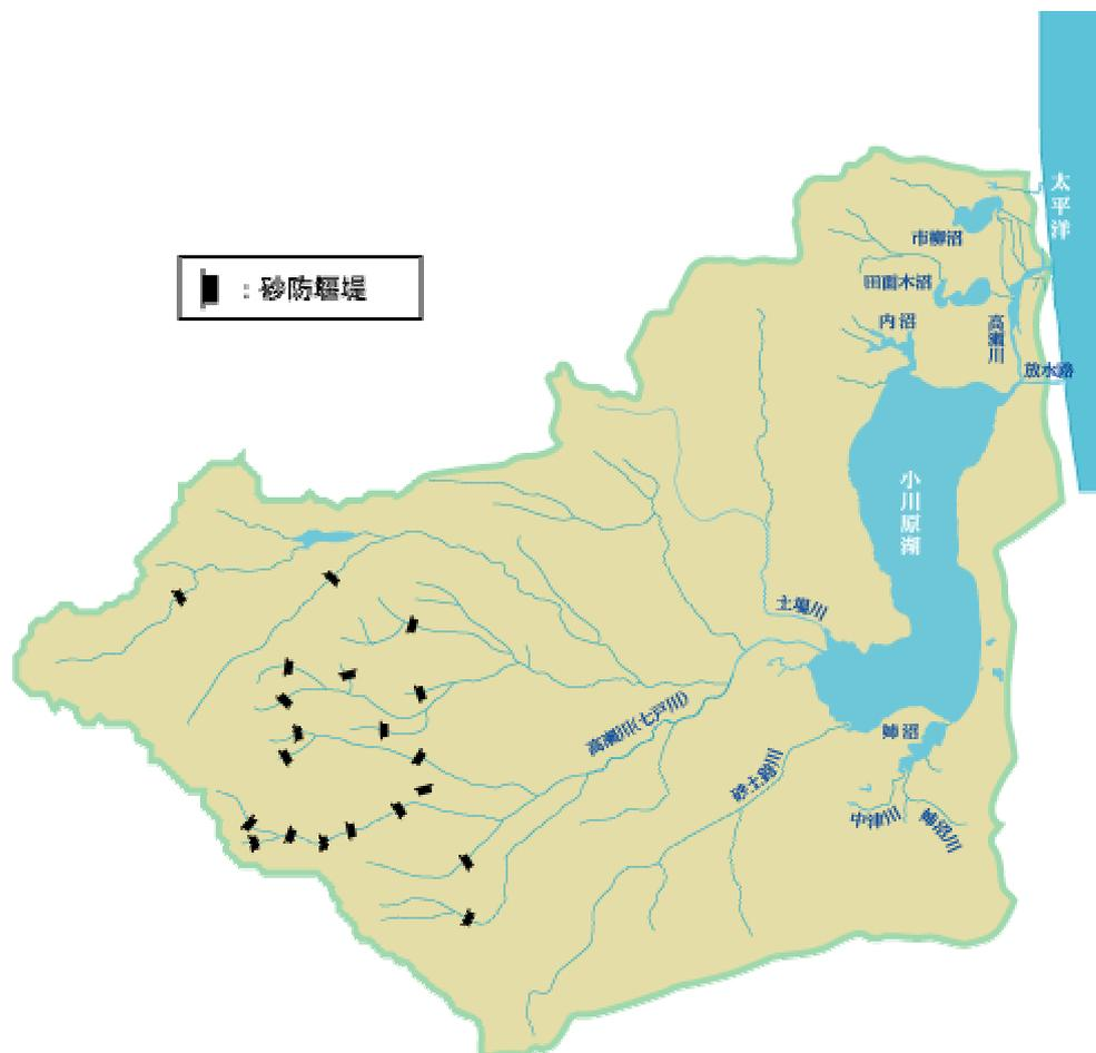
図 4.2.2 高瀬川流域における砂防堰堤位置図
